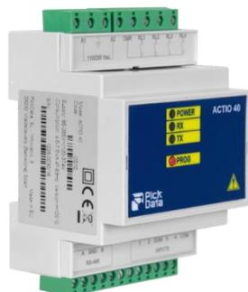
**ACTIO 40** es un equipo centralizador de contadores de energía con 4 entradas digitales (optoaisladas) para la lectura de impulsos que procedan de los contadores eléctricos, de agua, gas, etc. El valor de los impulsos se guarda en memoria.
